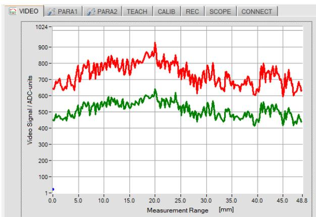
Die Graphik-Anzeige wechselt automatisch auf den VIDEO Tabulator. Hier wird das aktuelle Video-Profil (rot) und die daraus abgeleitete Video-Schwelle (grün) angezeigt.
