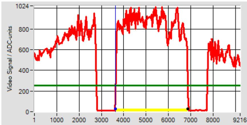
Eingelernt und ausgewertet wird das ZENTRUM (Mittelabstand) zwischen der ersten steigenden Kante (A = +1) und der zweiten fallenden Kante (B = -2) beginnend mit der Suchrichtung von Links bei Pixel 1.
