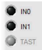
Der Zustand von IN0 wird an der Bedienoberfläche an der IN0 LED angezeigt. Bei einem HIGH-Pegel (+24VDC) leuchtet die LED grün. Die Zustandsänderung wird nur bei aktiver Daten-Übertragung aktualisiert !
