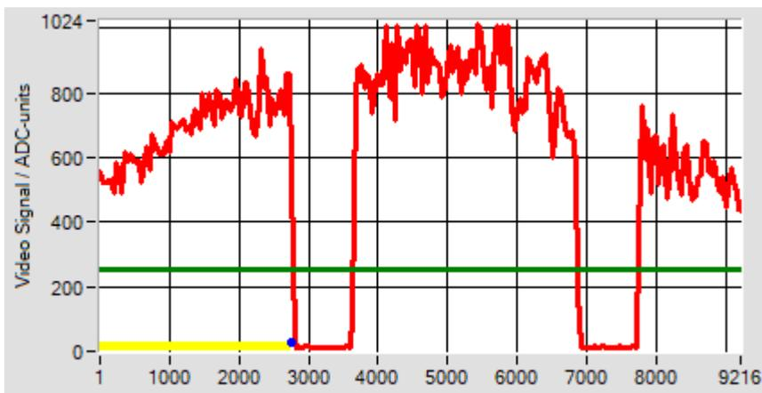
Eingelernt und ausgewertet wird die Position der äußersten Kante (A=0), beginnend mit der Suchrichtung von Links bei Pixel 1.
