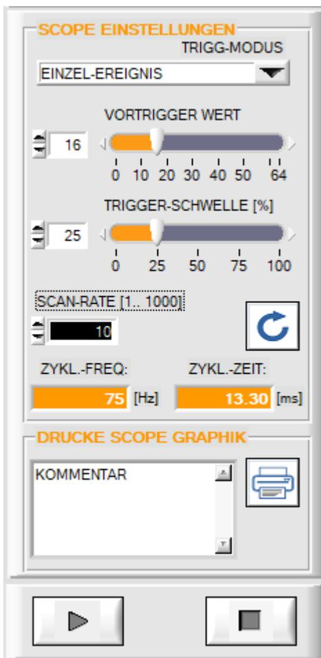
Die Aktivierung bzw. der Abbruch der Trigger Funktion erfolgt mit den beider Tasten START und STOP.
