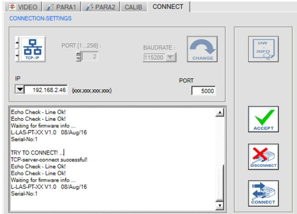
Zur Kommunikation des Sensors über ein lokales Netzwerk wird ein RS232 zu Ethernet Adapter benötigt. Dieser ermöglicht es eine Verbindung zum Sensor über das TCP/IP Protokoll herzustellen.
