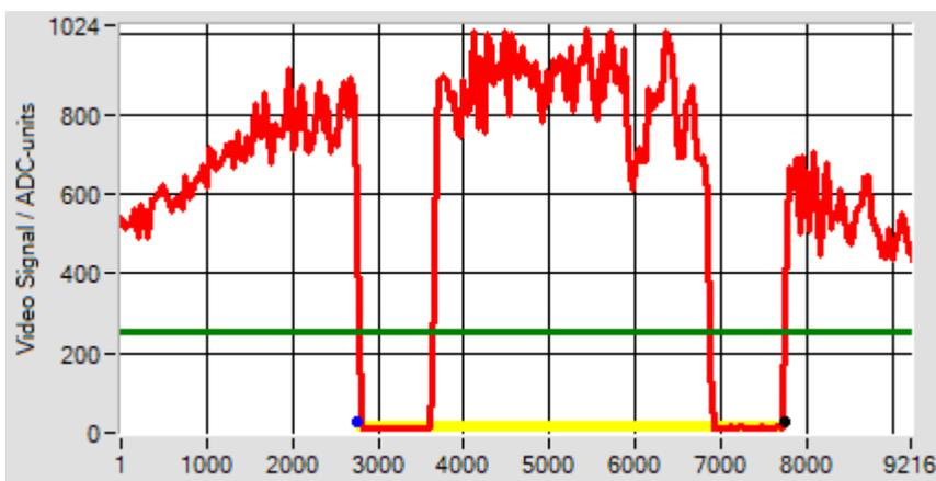
Eingelernt und ausgewertet wird das ZENTRUM (Mittelabstand) zwischen der ersten fallenden Kante (A = -1) und der zweiten steigenden Kante (B = +2) beginnend mit der Suchrichtung von Links bei Pixel 1.
