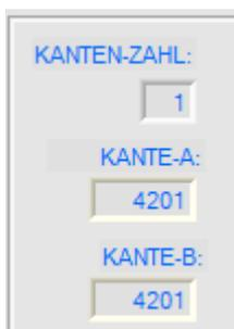
Ferner wird die Kantenposition und die erkannte Kantenanzahl in Numerischen Anzeigefeldern dargestellt.
