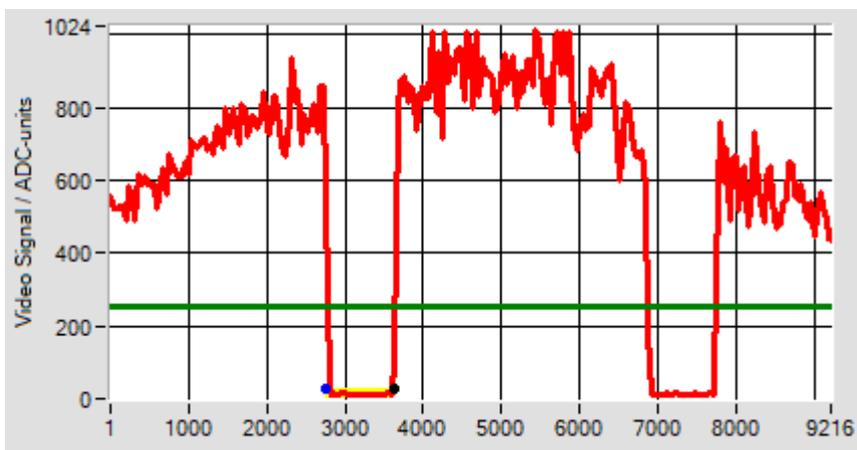
Eingelernt und ausgewertet wird die DISTANZ zwischen der ersten fallenden Kante (A = -1) und der ersten steigenden Kante (B = +1) beginnend mit der Suchrichtung von Links bei Pixel 1.
