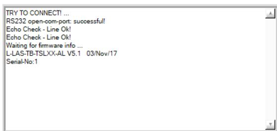
Beim Start der Software wird versucht, über die zuletzt verwendete COM Schnittstelle eine Verbindung zum *L-LAS-TB-...-AL Sensor* aufzubauen.
