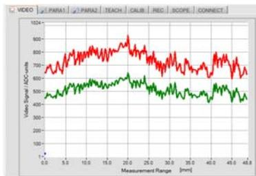
**Vor der Aktualisierung der Video-Schwelle muss sichergestellt werden, dass sich kein Objekt zwischen Sender und Empfänger befindet!**
